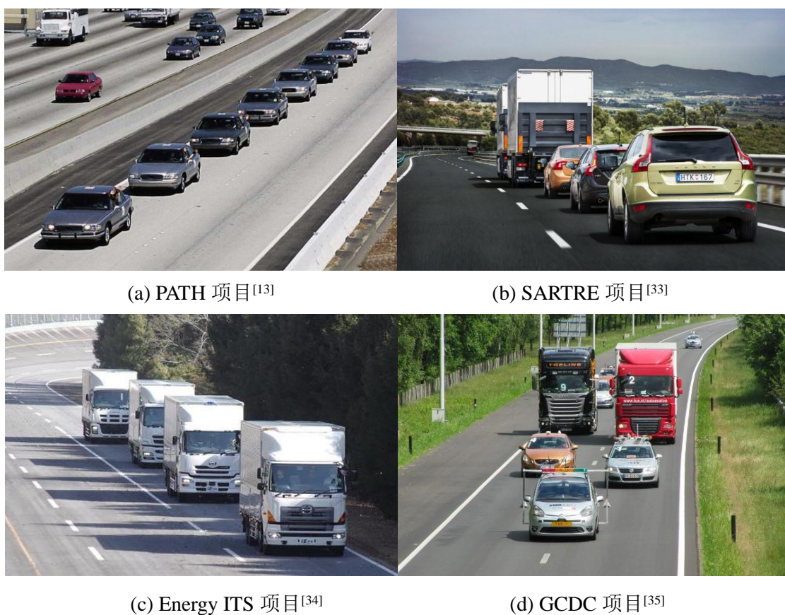
图 1-1 车辆队列的道路试验
